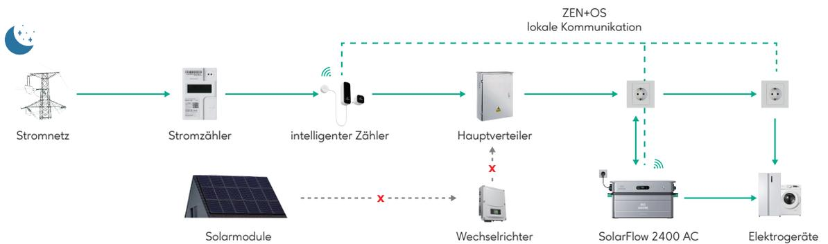
Tagsüber versorgt dich der SolarFlow 2400 AC mit Solarstrom und speichert überschüssige Energie in der Batterie. Abends speist die Batterie den gespeicherten Strom über den SolarFlow 2400 AC ins Hausnetz ein. Das effiziente Energiemanagement verringert deinen Strombezug aus dem Netz – und senkt deine Energiekosten.
